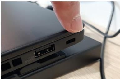
Dans les locaux du ministère votre ordinateur doit être **impérativement verrouillé**. Insérez le bout de l'antivol dans la fente sur le côté droit de l'ordinateur (photo de gauche) et poussez le bouton de l'antivol, utiliser la clé pour déverrouiller
